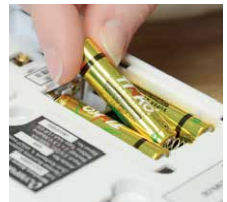
Die Basis kann den Strom auch aus drei Batterien (1,5 V; Typ: AAA) schöpfen; diese sind mit im Zubehör enthalten.
