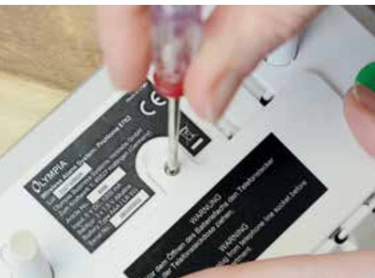
Eine Kreuzschraube hält die Rückklappe der Basis an Ort und Stelle.
