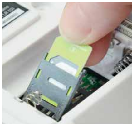
Darunter ersichtlich ist der SIM-Karten-Halter, der sich nur mit Mini-SIM-Karten ( UICC ) beschicken lässt. Für andere Formate ist ein Adapter vonnöten.
