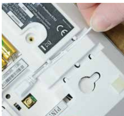
Das Stromkabel kann in ordentlicher Art und Weise in die Rillen eingelegt werden.
