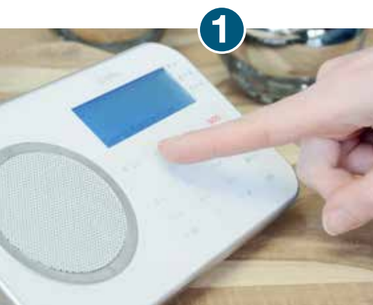
Vorab ist die Tastensperre der Basis durch Eintippen des PINs und Drücken von OK auszuschalten.
