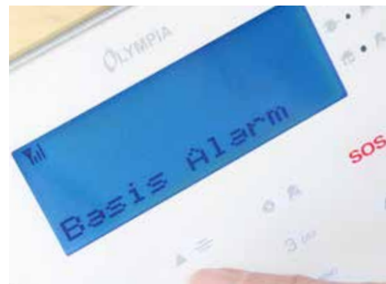
Das blau hinterleuchtete Display lässt sich recht leicht ablesen; das Kontrastlevel ist übrigens einstellbar (1 bis 5).
