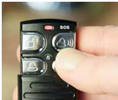
Mit der Fernbedienung lässt sich jederzeit – auch ohne Auslösen eines Sensors – ein Alarm absetzen (SOS). Daher sollte man sie auch im Haus immer bei sich haben.
