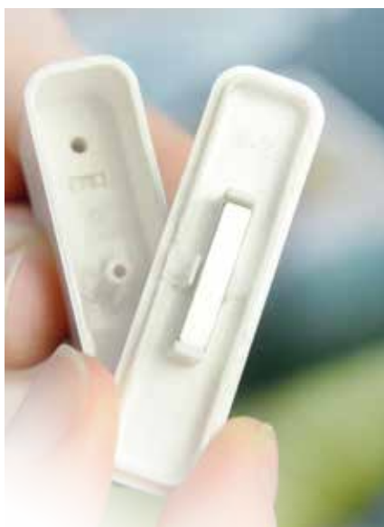
► Das korrespondierende Element des Tür-/Fensterkontakts schaltet durch den in ihm verbauten Magneten den Reed -Schalter des Sensors.
