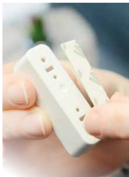
► Die Rückseiten der Sensoren sind jeweils mit einem Klebestrip zu versehen; diese haben von Werk aus das passende Maß.
