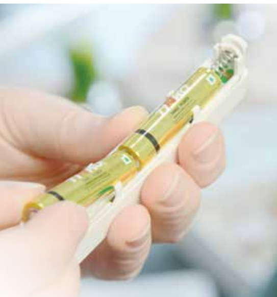
► Jeder Tür-/Fensterkontakt ist jeweils mit zwei Batterien (1,5 V; Typ: AAA) zu versehen.
