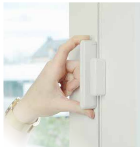
► Es ist jeweils ein Sensorelement am Fenster und am Fensterrahmen zu positionieren (im Test in einem Abstand von maximal 1,5 cm zueinander).
