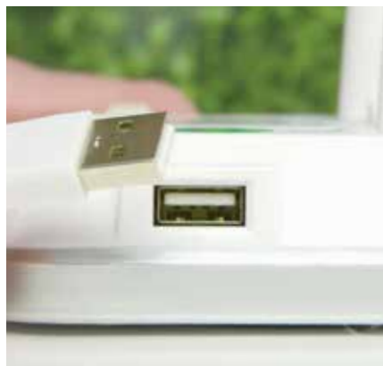
Die USB-Schnittstelle erlaubt es, später geplante Erneuerungen/Erweiterungen (bspw. in Bezug auf den jeweiligen Funkstandard) einzuspielen.
