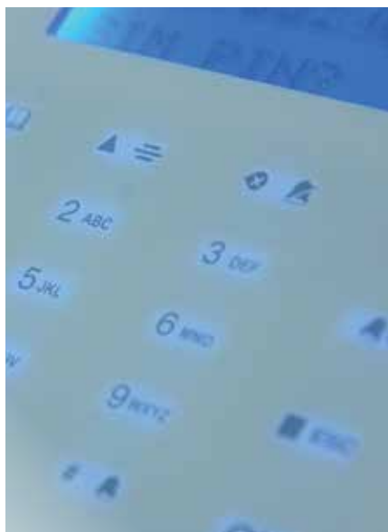
► Die einzelnen Tasten der Basis sind maßvoll blau hinterleuchtet; so lassen sie sich auch bei Nacht problemlos erkennen.
