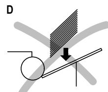
► Verschieben Sie die Banknoten im Bündel so, dass die obere Banknote tiefer liegt als die nächste. Legen Sie die Banknoten so in das Einlegefach (A).
