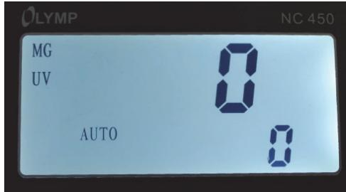
Wird ein Fehler festgestellt, wird dieser in der oberen Anzeige angezeigt (siehe Fehlertabelle) und der Hintergrund wird rot.
