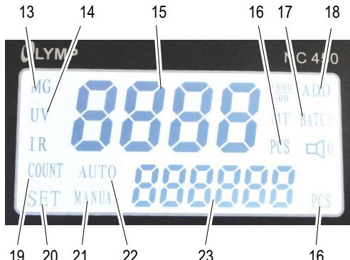
Die Abbildung zeigt das Display während der Selbstdiagnose. Einige der dargestellten Anzeigen gehören nicht zum Funktionsumfang dieses Banknotenzählgeräts.
