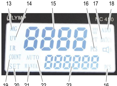
De afbeelding toont het display tijdens de zelf-diagnose. Sommige van de weergegeven displayelementen worden niet gebruikt voor dit bankbiljetten-telapparaat.
