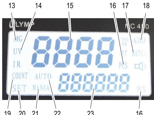
La raffigurazione visualizza il display durante l'esecuzione dell'autodiagnosi. Alcune delle funzioni visualizzate non fanno parte delle dotazioni del presente contatore di banconote.
