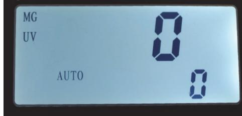
Si se detecta algún error, este se muestra en el indicador superior (ver la tabla de fallos) y el fondo de la pantalla cambia a rojo.
