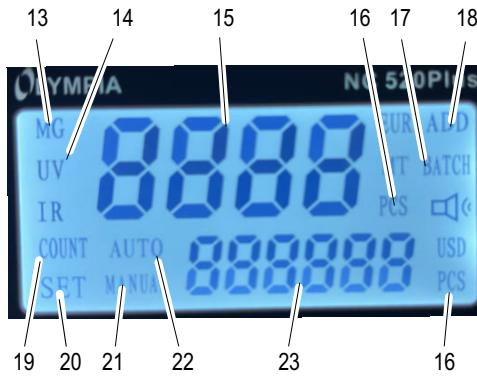
De afbeelding toont het display tijdens de zelf-diagnose. Sommige van de weergegeven displayelementen worden niet gebruikt voor dit bankbiljetten-telapparaat.
