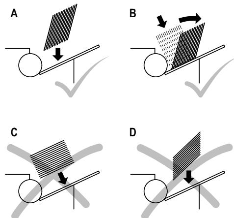
► Verschieben Sie die Banknoten im Bündel so, dass die obere Banknote tiefer liegt als die nächste. Legen Sie die Banknoten so in das Einlegefach (A).
