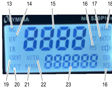
Die Abbildung zeigt das Display während der Selbstdiagnose. Einige der dargestellten Anzeigen gehören nicht zum Funktionsumfang dieses Banknotenzählgeräts.
