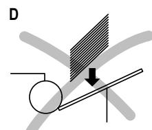
→ Déplacer les billets de la liasse de telle sorte que le billet supérieur soit plus bas que le suivant. Introduire ainsi les billets dans le bac d'alimentation (A).
