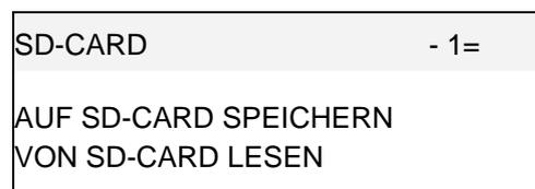
Die aktuelle Programmierung und die Berichte (ohne Elektronisches Journal) werden von der Kasse zur SD-Karte übertragen und gespeichert.
