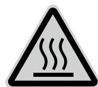
**VORSICHT!** Verbrennungsgefahr durch heiße Geräteoberfläche. Während des Laminierens erhitzt sich die Geräteoberfläche. Die Geräteoberfläche während des Betriebs nicht berühren. Warten Sie nach dem Betrieb einige Minuten, bis sich das Laminiergerät abgekühlt hat, bevor Sie die Geräteoberfläche berühren.
