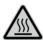
**PRUDENCE !** Risque de brûlure dû à la surface de l'appareil devenue brûlante pendant la plastification à chaud. Ne pas toucher celle-ci pendant le fonctionnement de l'appareil. Après la plastification, attendre le refroidissement de la plastifieuse pendant quelques minutes avant d'en toucher sa surface.
