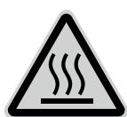
**ATTENZIONE!** Pericolo di ustioni dovute alle pouches per plastificare calde. La pellicola in uscita dall'apparecchio subito dopo la plastificazione è molto calda. Per estrarre le pouches dopo la plastificazione, afferrarla solo da un'estremità raffreddata.
