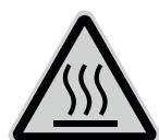
**¡PRECAUCIÓN!** Peligro de quemaduras provocado por restos de laminación calientes. El papel saliente conlleva restos de laminación muy calientes. Retire el papel saliente por el extremo enfriado.
