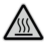
**PRUDENCE !** Pendant le process de plastification et le nettoyage, la sortie du papier entraîne des résidus très chauds. Ne retirez-le que par son extrémité refroidie.
